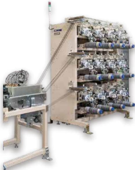
TPSプリプレグスリッターでスリットした1/8"、1/4"、1/2"、1"などの細幅テープを巻き取るトラバース巻装置です。巻取軸はポビントラバース式を採用。個別のテープ張力は津田駒独自の張力制御技術によりコントロールされています。ライナー送付も各軸に装備しており、熱硬化性材料のテープをライナーフィルムと一緒に巻き取ることで、AFP装置で利用する材料の製作が可能です。
