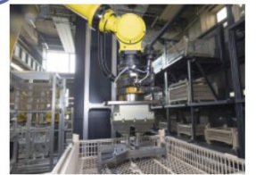
段積みワークをカメラで対応
