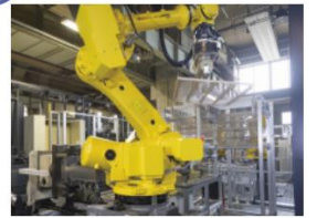
段積みワークの間仕切り網の出入れなどもロボットで自動化
