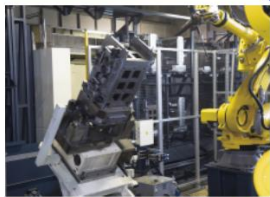
傾斜割出台でジグを倒すことにより平置きでのワーク搭載が可能
