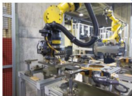
ハンド6種類、反転台3台で約50種類のワークに対応
