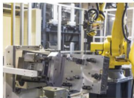
ジグ傾斜割出台の円テーブルによりイケール4面にワーク搭載が可能
