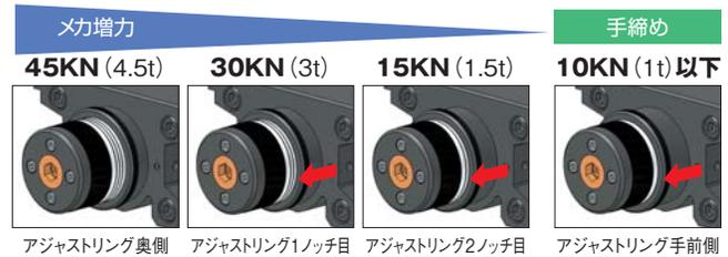
ラクラク操作のメカ増力機構
