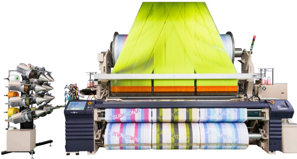
新机种“ZAX9200i-Terry”搭载新型电装品·Navi键盘，是一台高速操作性进一步提高的毛巾专用喷气织机。
