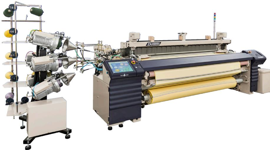
“ZAX9200i”采用新型6节连杆打纬实现了清晰的开口和飞行角的扩张，通过*i-Weave*、DSS-II直供副喷嘴系统等，即使是6喷，也能发挥出超群的高速稳定性和耗气量削减10%的节气性能。
