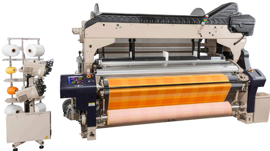
“ZW8100”对机架结构、打纬机构、开口装置进行了最优化设计，同时配置新型短间距喷嘴和新型6连杆短冲程打纬，从而使其高速性能比前代机型提高10%，却耗电却减少5%，机上振动大幅降低50%。在织物品质不受影响的条件下，发挥了其高速性。
