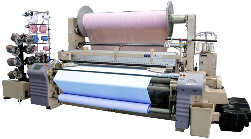
电气控制系统和引纬零件、动力零件等主要部分均采用津田驹工业株式会社在日本生产的原装配件，与中国的合理生产体制相融合制造出的日中合资织机，现场演示高附加值织物的织造。
