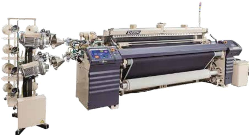
中国市場で、Air Jet“Denim”をアピールいたします。今や世界的にデニム製織の主流となっているAJL。ZAX9200i エアジェットルームによるデニム製織は、デニム製品の生産性を高め、超高速にも関わらず、高品質なデニムを製織します。また、アジャスタブルガイドバーの採用で通し幅に合わせたガイドバーの切断が不要になり、機替え時間の大幅な短縮ができます。
