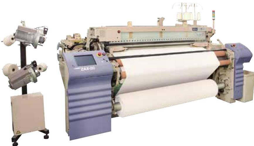
Navi键盘的使用实现了织造支援、便捷的操作性以及高生产性, 进而降低了织造成本。于此同时, 刚性能高框架构造将厚重织物的良好稳定超高速运转付诸于现实。
