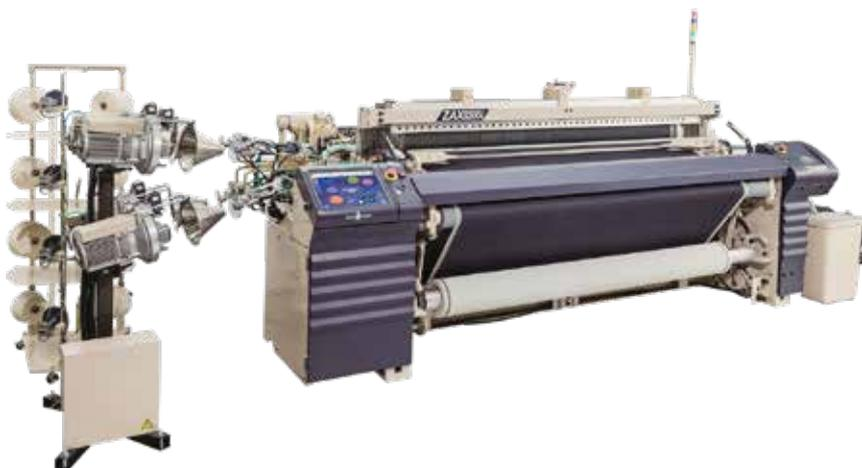
我们将在中国市场推广“喷气织造牛仔布AIR JET DENIM”工艺。喷气织机已成为当今全球性牛仔布织造的主流。使用 ZAX9200i 进行的牛仔布织造不仅提高了生产性，而且实现了超高速前提下的高品质牛仔布织造工艺。同时，使用可调节托布杆取代了配合上机穿箱门幅切断导布杆的操作，大幅缩短了换机时间。
