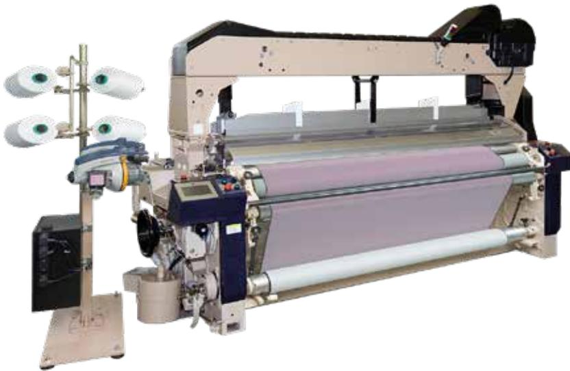
我们将现场演示高市场需求的230cm公称箱幅喷水织机的高速稳定运转。从普通成衣面料到中等厚重的高附加值织物, 实现了以最小的运行成本进行多品种的织物织造。
