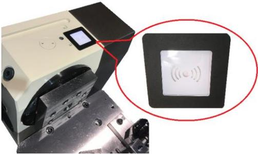
ボールドライブ NC 円テーブルにセンサーを搭載
