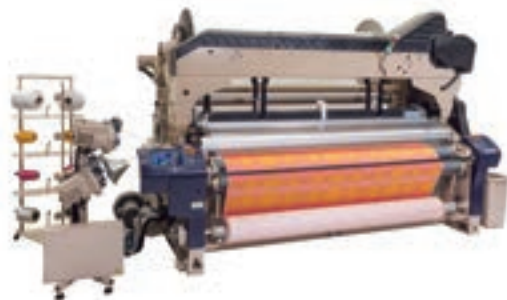
水でヨコ糸を挿入するウォータージェットルーム(ドビー仕様)
