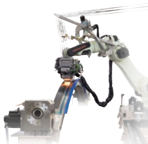
国産初の小型ロボットタイプCFRP曲面積層機
